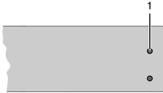
Abb. 7 Chassis-Vorderseite mit Modul-LEDs
