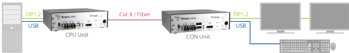
Abb. 23 Installationsbeispiel (System mit zwei Monitoren über MST Daisy-Chain)
